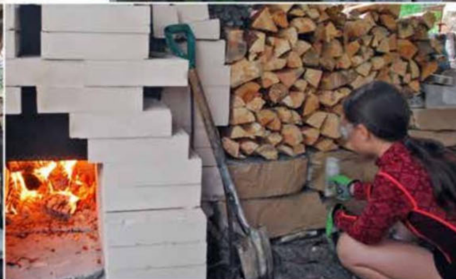
TO DAGERS KALKBRENNING i testovnen med 7. klasse på Hyllestad skule (2019). Ungdommen gjorde alt: Hogde ut marmor, knuste den, fylte ovnen, stablet ved, spilte fanfare ved brennstart, tok nattevakter, pakket brennt kalk i bøtter, lesket og slemmet med egenbrent kalk. Håndverk i praksis for de unge.
