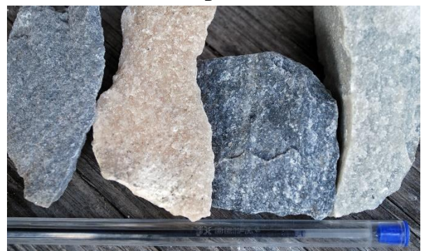
Figur 4: Varianter av Mostermarmor Austra. A: Den vanligste, gråhvite typen. B: Båndet og foldet gråblå og gråhvite type. C: Folierte rosa og gråhvite typer med tynne bånd av glimmerskifer. D: Alle typene på ett Brett, fra venstre; mørk gråblå, svakt rosa, lett båndet blålig og grålig, lys gråhvite. Foto: Per Storemyr
