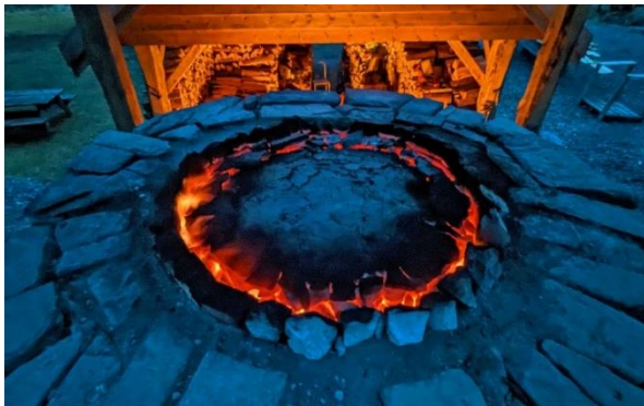
Figur 8: Deler av brenneprosessen. A: Oppfyring med damp når fukt brennes av. B: Inntrykk fra kontinuerlig fyring. C: Glød under leiretildekning lagt på i toppen for å holde på varmen. D: Ild på toppen etter ilegg av ved. Foto: Per Storemyr
