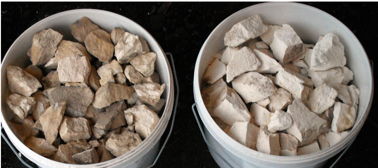
Figur 12: Eksempel på sortert Mosterkalk. T.v. beige, lett uren kalk, t.h. hvit, nær ren luftkalk. Foto: Per Storemyr
