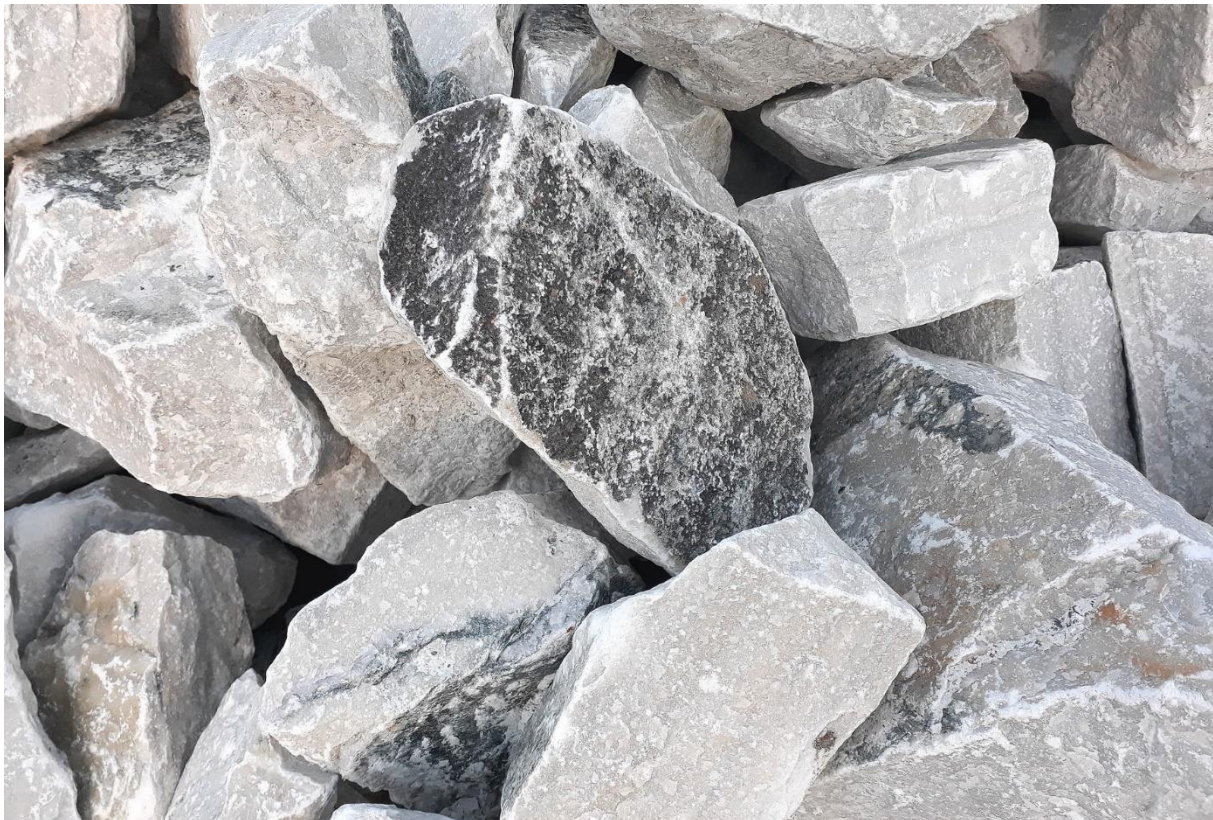
Figur 6: Ferdig opphogde marmorstykker etter første sortering. Stykkene er hvite til lyst gråhvite med et meget svakt brunlig til rosa skjær. Mørke flater har tynn glimmerskifer langs foliasjonen. Mange stykker med glimmerskifer blir sortert manuelt bort før marmoren blir stablet i ovnen. Blokkene her er 20-30 cm lange. Foto: Per Storemyr
