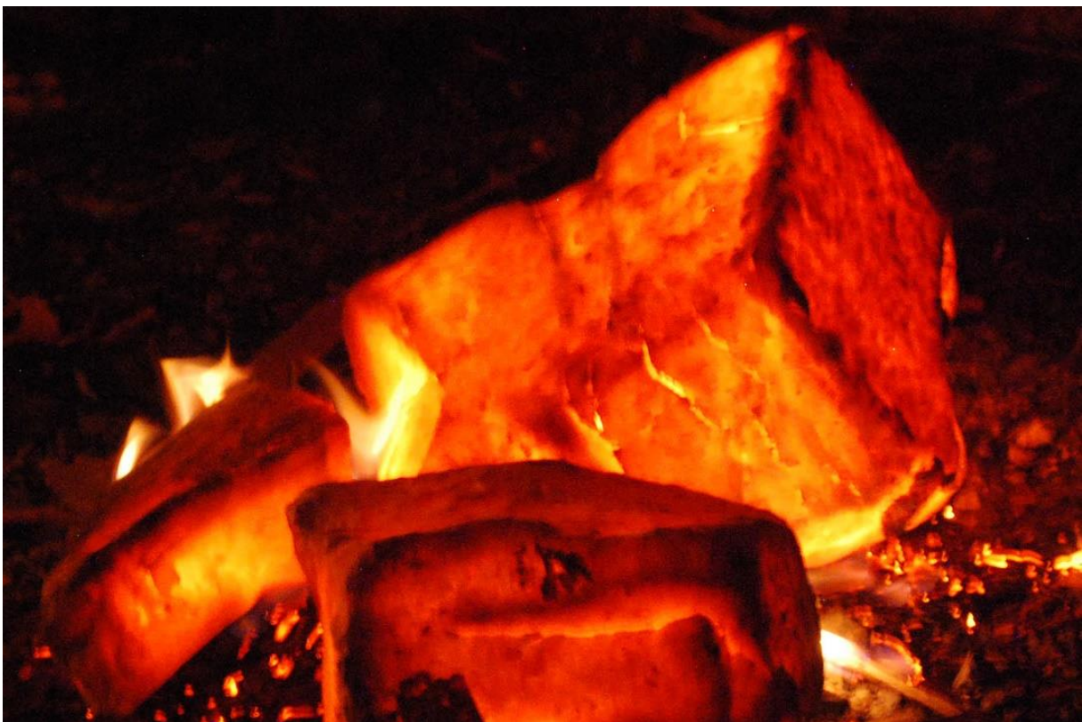
Figur 9: Gjennombrant marmor tatt ut fra ovnen. Overflaten kjøles raskt ned, men inni kan en se gulvitt glød som indikerer temperatur på over 900°C. Lengden på stykket er ca. 20 cm. Foto: Per Storemyr
