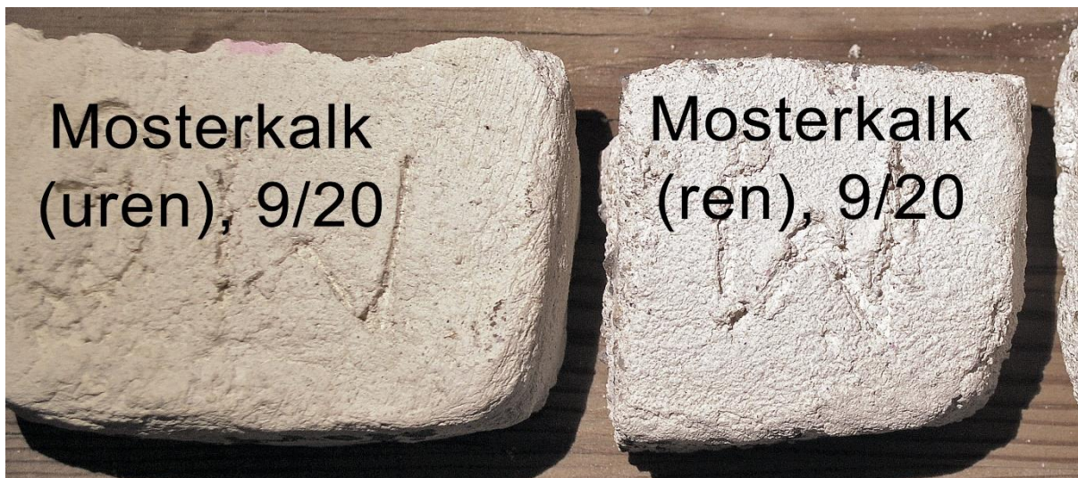
Figur 15: Prøvemørtler. T.v.: Basert på lett uren, beige Mosterkalk. T.h.: Basert på renere, hvit Mosterkalk. En ser at fargen på prøvemørtlene gjenspeiler renheten i kalken, selv om forskjellen ikke er betydelig. Foto: Per Storemyr
